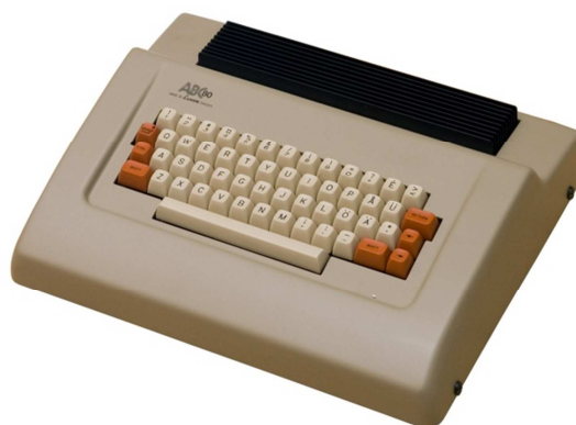
ABC-80 Svéd gyártmányú, Z80 alapú számítógép http://www.pdp-9.net/luxor-abc80
