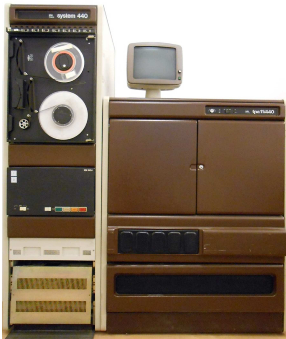
TPA 11/440 központi egység bolgár mágnes-szalagos és lemezes perifériával (PTE TTK informatika gyűjtemény)
