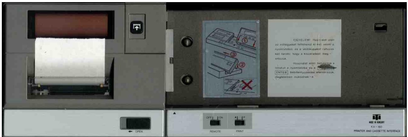
Nyomtató: 57 mm széles papírszalagra dolgozó négyszínű grafikus nyomtató
