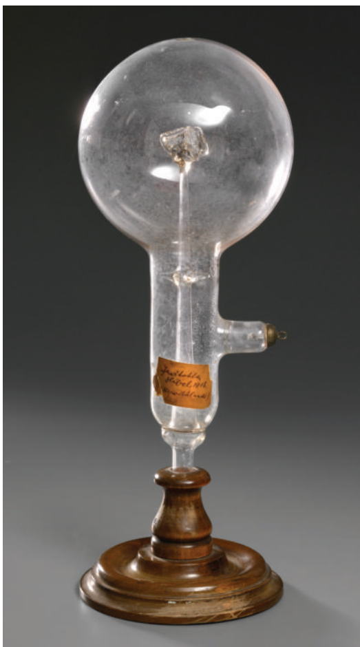
Crookes-cső 1887-ből (BpFizLelt L52).
