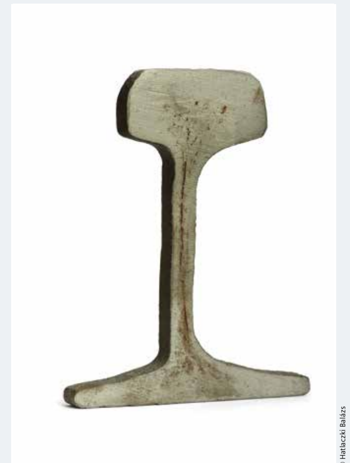
A Millenniumi Földalatti Vasútnál használt aszimmetrikus sín metszete, amelyet kizárólag ennél a vasútnál alkalmaztak, 1896
