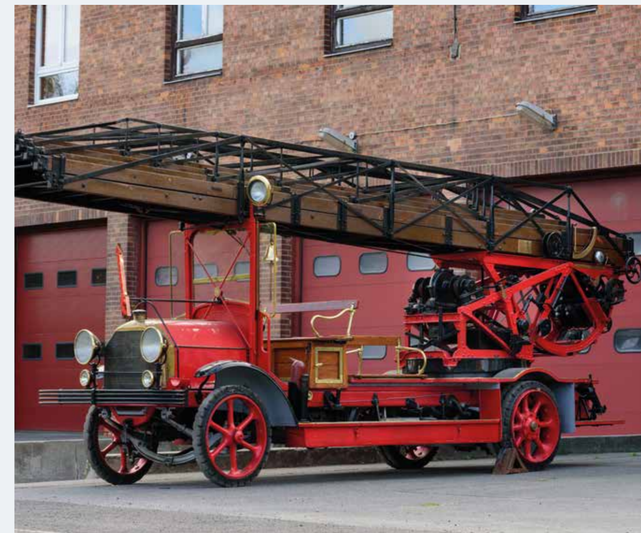
Tűzoltóautó 1914-ből, Austro-Daimler Magirus gépezetes tolólétrával, amelyhez a Siemens gyártotta az elektronikát (A Katasztrófavédelem Központi Múzeumának tulajdona)
