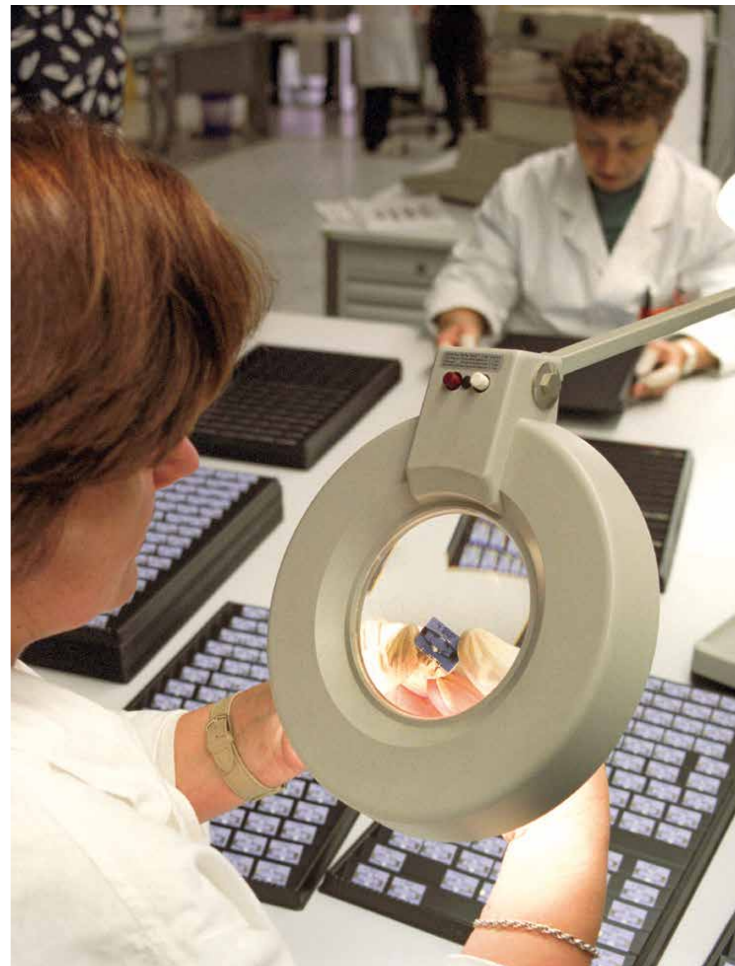
A Siemens Rt. 1996-ban bővített bicskei üzemében a legkorszerűbb körülmények között állították elő az ipari elektronikai rendszerekben használatos korszerű komponenseket: hibrid áramköröket és teljesítménymodulokat. A 2000 négyzetméteres, klimatizált gyártórészlegében 150 fő dolgozott
