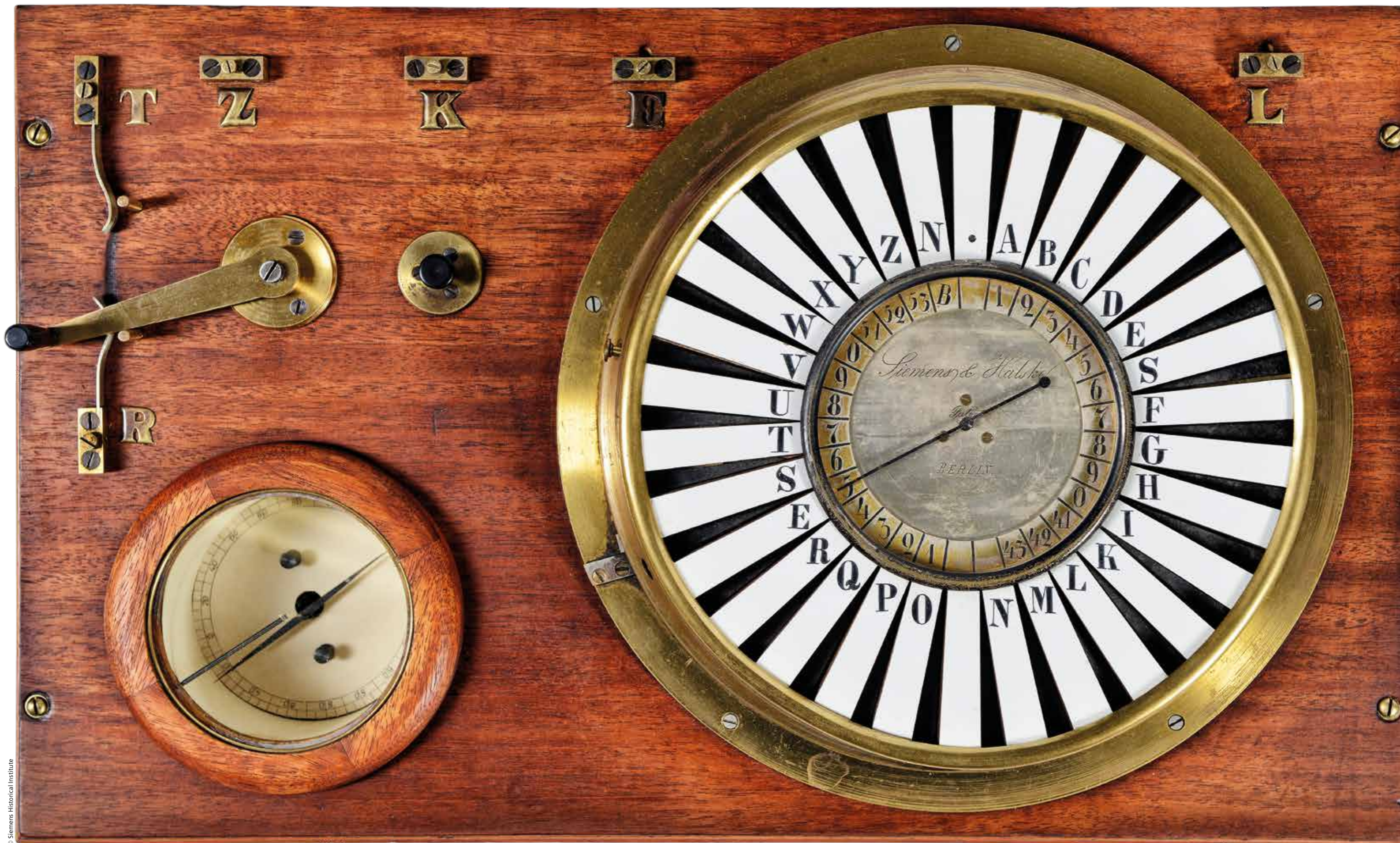
Siemens mágnesűs táviró replikája, 1847
