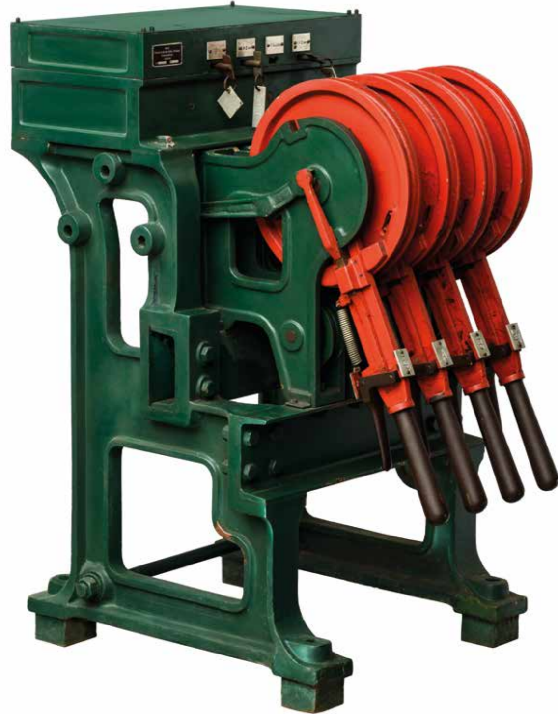
A vasútállomások forgalmi irodáján elhelyezett biztosítóberendezés, amellyel a váltókat, jelzőket és egyéb épületen kívüli, vasútbiztonságért felelős berendezéseket lehetett vezérelni
