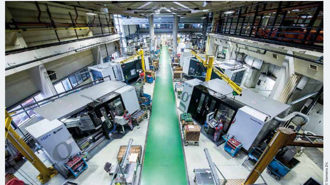
Az üzemben gyártják a legkorszerűbb gáz- és gőzerőművekbe beépülő turbinalapátokat és nagyméretű acélkomponenseket
