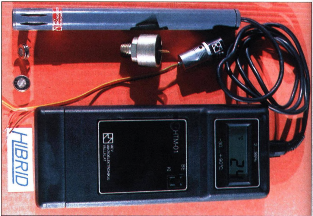
16.20. ábra. Relatív páratartalom és hőmérséklet mérő kéziműszer+érezkelő fej. MEV 1989.
