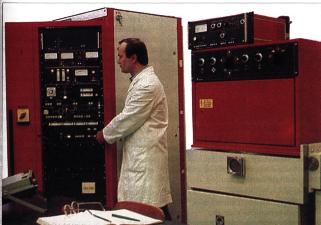
16.4. ábra. Korszerű porlasztó berendezés (zsilipkamrás, 4-targetes, nagyfrekvenciás, programozható üzemű. HIKI 1978)
