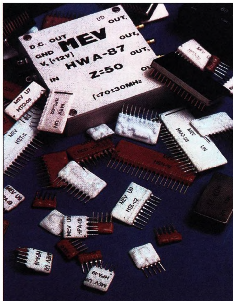
16.1. ábra. Tokozási megoldások a HIKI hibrid áramköreinél a 70-es 80-as évekből
