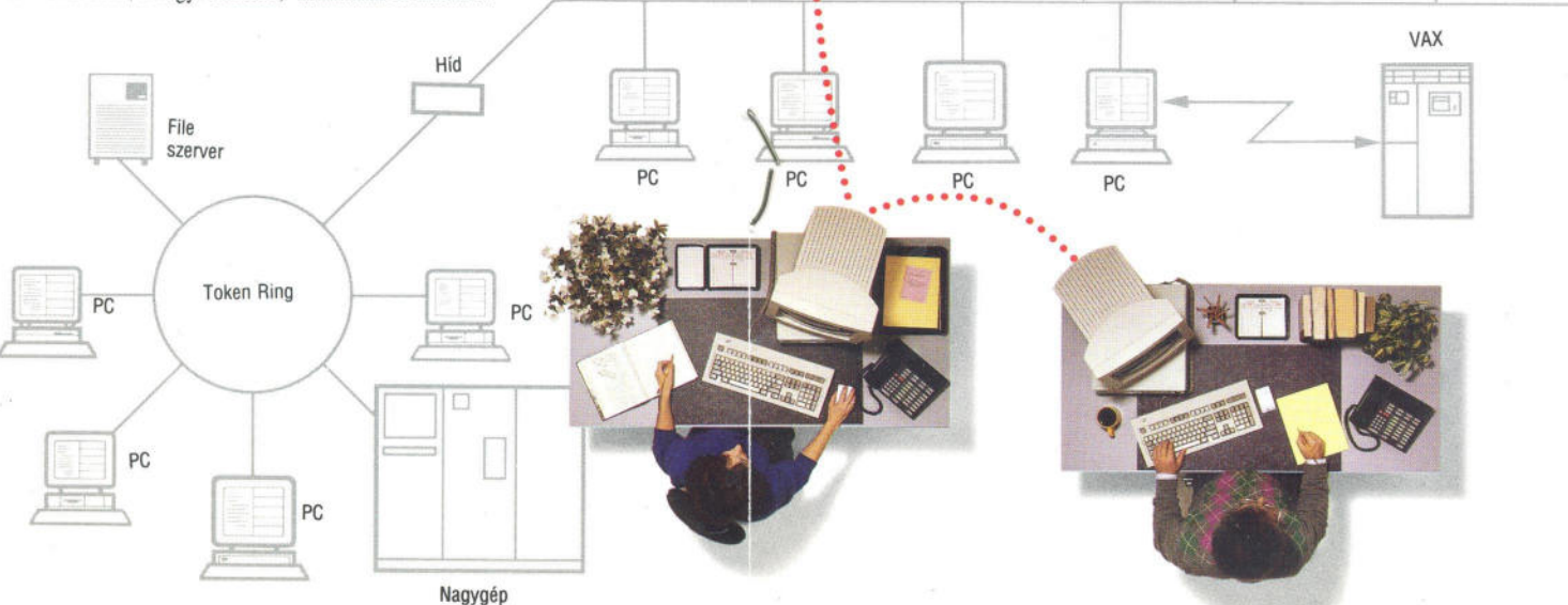
A kliens-szerver architektúra különösen alkalmas üzleti folyamatok automatizálására. Lehetővé teszi, hogy nagyteljesítményű mikroprocesszor vezérelt munkaállomások és szerverek gyorsan és gazdaságosan kezeljék a különböző méretű alkalmazások tranzakciós igényeit. Az olyan funkciókat, mint az iratbevitel, képezés, lekérdezés vagy nyomtatás, a helyi hálózat nagyteljesítményű szerverei látják el. A munkaállomások nem csupán az információ megjelenítést végzik, de az üzleti tevékenységét támogató alkalmazások is rajtuk futnak. Ez az architektúra pontosan oda koncentrálja a számítógép teljesítményét, ahova szükséges.
