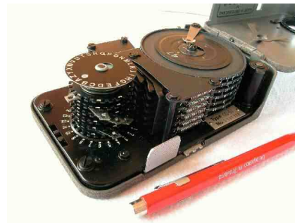
Boris Hagelin tárcsás kézi rejtjelző gépe és annak belső szerkezete.
