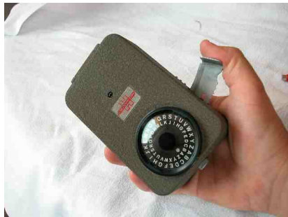
Boris Hagelin tárcsás kézi rejtjelző gépe és annak belső szerkezete.
