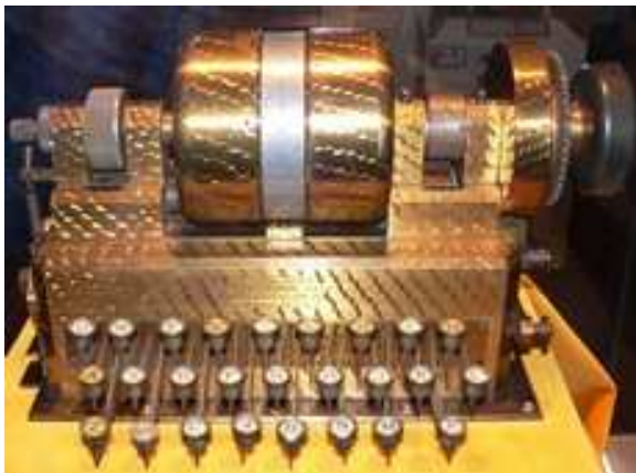
4.6. ábra Hebern első rotoros rejtjelző gépe (1917)
