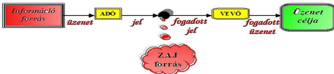
6.1. ábra A kommunikációs rendszer általános modellje CE..Shannon 1948-as cikkében
