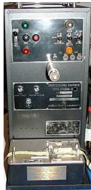
Az ETCRRM típusjelű rejtjelző gép, amely a Washinton/Moszkva „forródrót” kommunikációját biztosította
