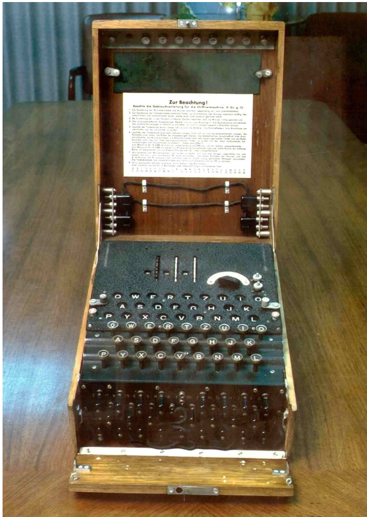
A dugaszoló aljzattal (stekkerrel) szerelt Enigma rejtjelző gép
