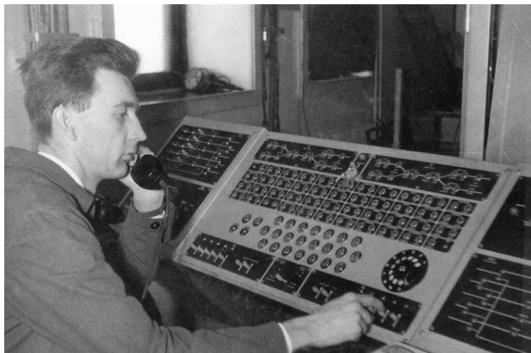
Az FMV gyártású GTT 4000/A típusú berendezés távfelügyeleti kezelőasztala (A Postamúzeum gyűjteményéből)
