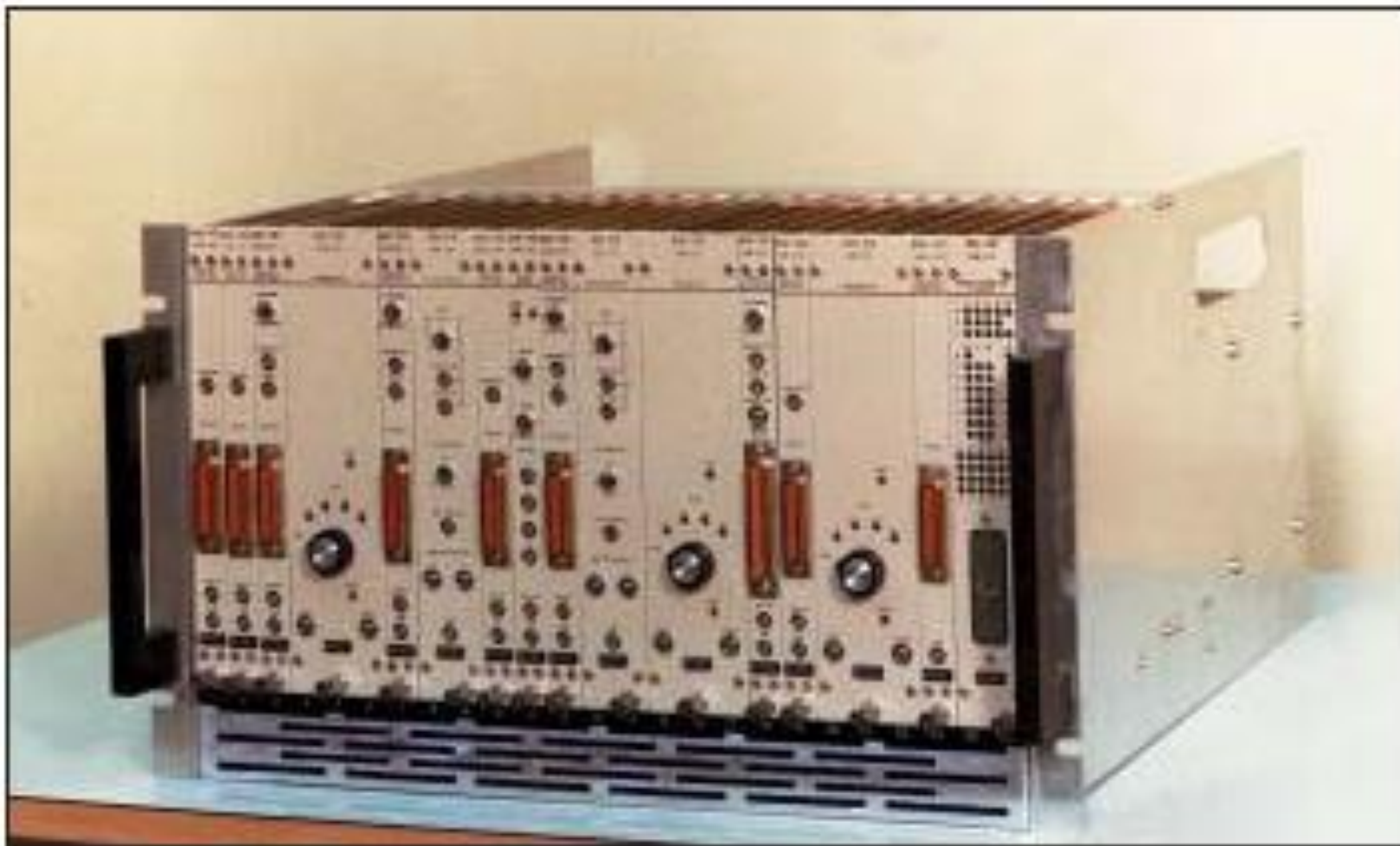
16. kép CAMAC keret modulokkal
