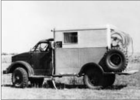
20 Szovjet gyártmányú, SzSz-24 típusú 24 csatornás szeizmikus műszerkocsi (Gaz-61 – azaz „Molotov” – teherautó, 50-es–60-as évek)
