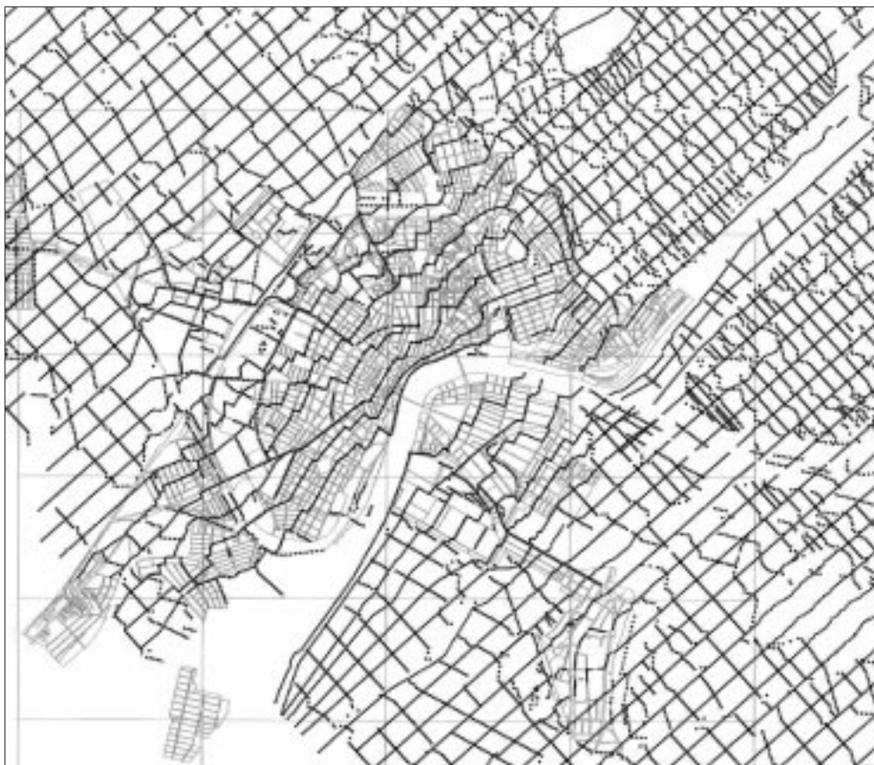
34. ábra: A Szeged 3D projekt belterületi részének megvalósult mérési hálózata (a geofonvonalak általános iránya DNY–ÉK). Jól láthatók a város szerkezetéből adódó geofon- és vibrátorvonal „torzulások”. (a MOL engedélyével)
