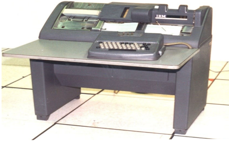
IBM programdob vezérelt, másolóágyas, lyukasztó / ellenőrző gép
