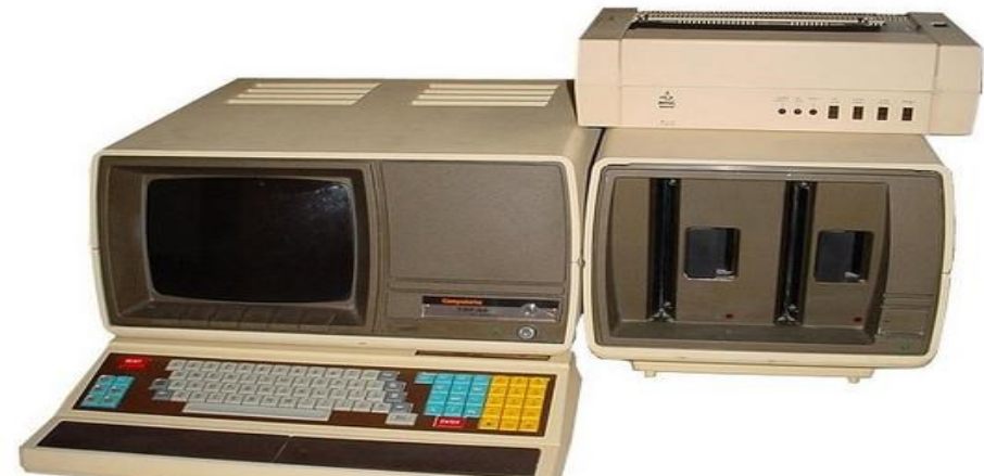
TAP-34 a Telefongyárban fejlesztett és gyártott intelligens terminál.
